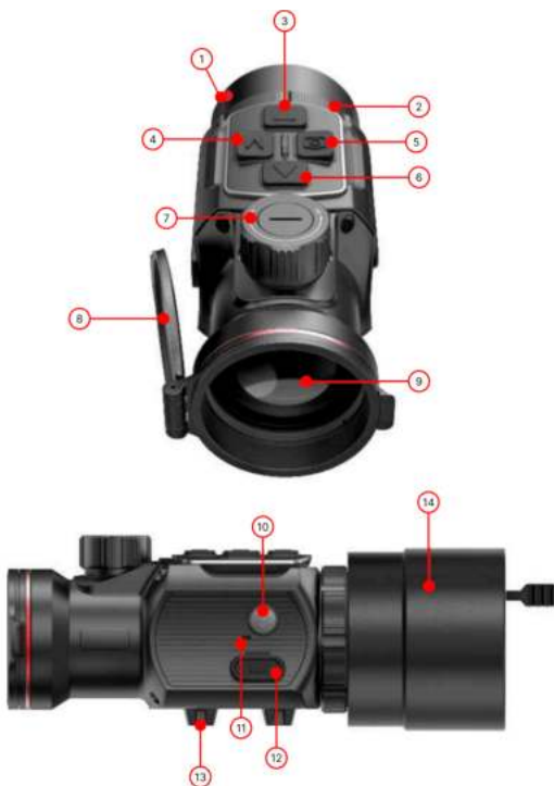
Рис. 1. Устройство тепловизионной насадки Longot Mate Y050 (MAH50)
